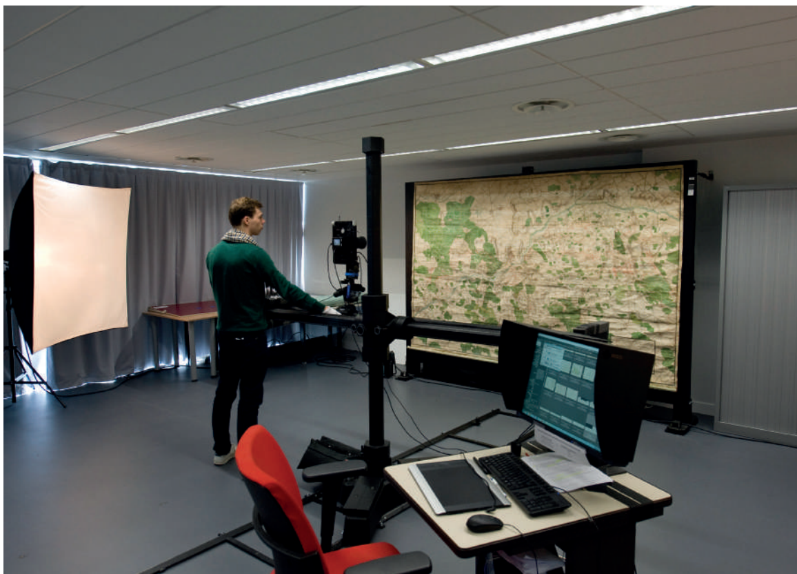
Figure 1 : studio grand format, avec station informatique et plateau aspirant (surface en tôle perforée permettant de maintenir les documents par aspiration) (© Archives nationales, France)
