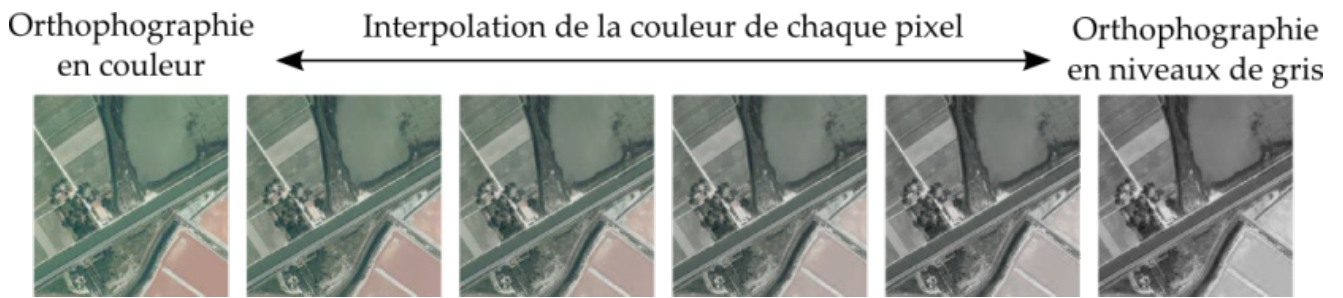
Figure 3 : Interpolation de la couleur pour des données de type raster, entre une orthophotographie en couleurs et sa conversion en niveaux de gris.
