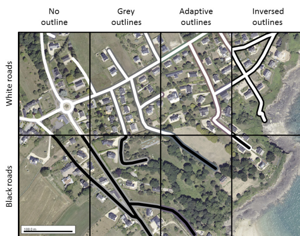
Figure 6 : Différentes méthodes pour adapter le symbole des routes à la photo en optimisant le contraste local.
