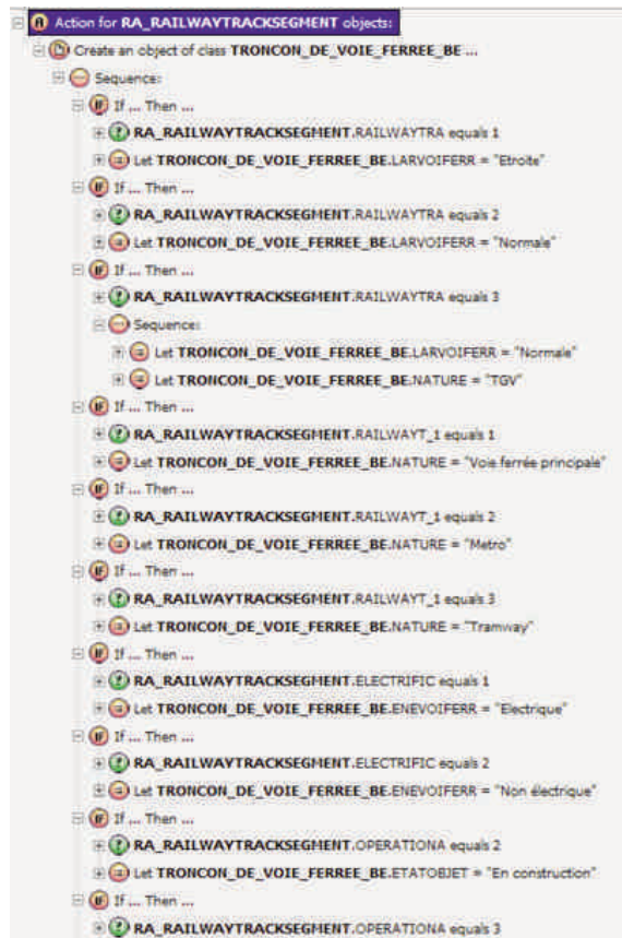
Figure 7 : Exemple de règles introduites dans Radius Studio pour traduire les données belges dans le schéma français de la BDUi.
