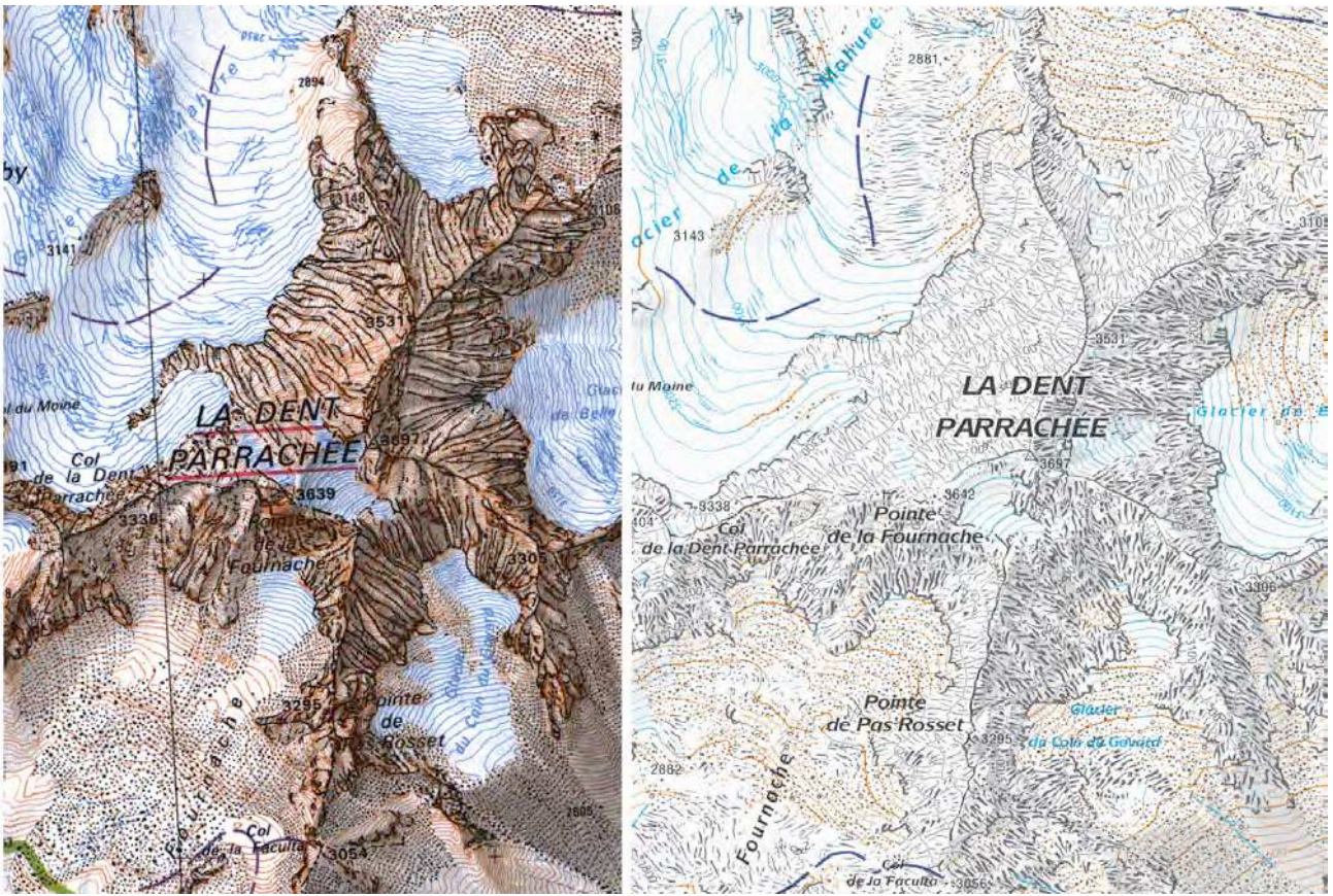
a) Ancienne carte dessinée manuellement b) Nouvelle carte obtenue automatiquement Figure 3 : Comparaison de représentation du relief en haute montagne sur la feuille de Modane
