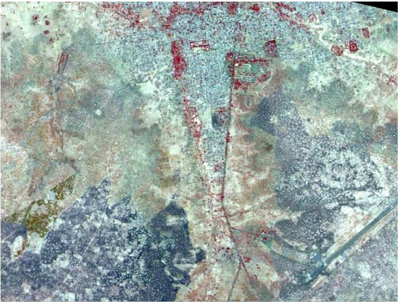
Figure 3 : Extrait d'image 5m couleur résultant de la fusion d'une image Landsat 7 ETM+ (Canaux 234) et d'une image SPOT 5 Panchro sur la ville de Tambaounda
