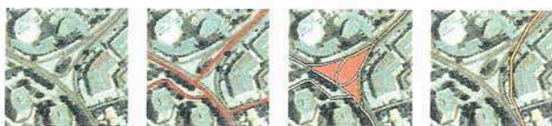
Fig. 1 Une orthophotographie représentant le monde réel et la saisie du réseau routier selon les spécifications de trois bases de données de résolutions différentes.
