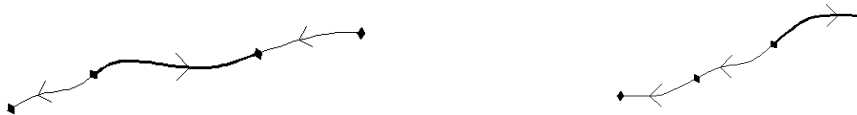
Figure 3 : (a) le tronçon en gras a un mauvais sens d'écoulement car il y a incohérence avec ses voisins ; (b) le tronçon en gras a un mauvais sens d'écoulement car il y a incohérence avec ses voisins et il est le premier tronçon d'une rivière, issu d'une source
